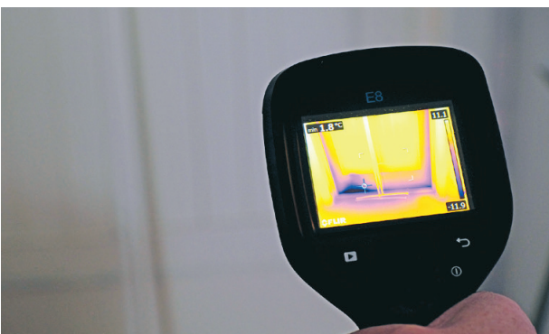
Med hjälp av en värmekamera kan du hitta värmeläckage. Foto: Silva Herrmann
